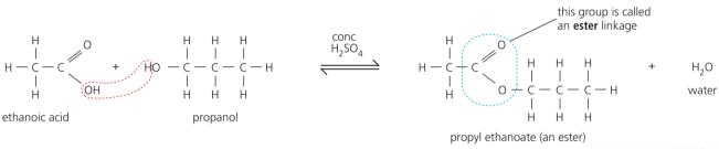
or  $CH_3COOH(l) + C_3H_7OH(l) \stackrel{conc. H_2SO_4}{=} CH_3COOC_3H_7(l) + H_2O(l)$
